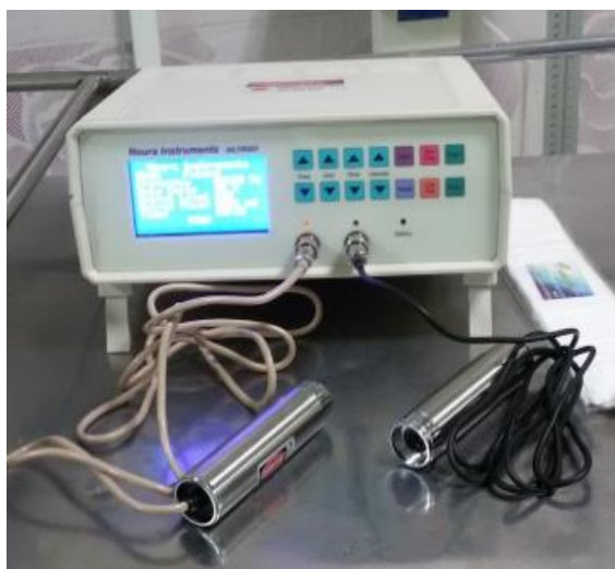
شکل ۱ دستگاه لیزر درمانی در سطوح پایین با لیزر نیمه هادی دارای دو پروب مرئی و مادون قرمز
