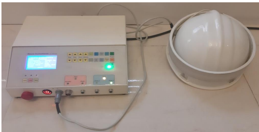
شکل ۱ دستگاه لیزر و میدان مغناطیسی ترانس کرانیال شامل هلمت محتوی ۲۴ عدد لیزر نیمه هادی و میدان مغناطیسی (راست) و نمای داخل هلمت (چپ)
