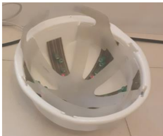
شکل ۱ دستگاه لیزر و میدان مغناطیسی ترانس کرانیال شامل هلمت محتوی ۲۴ عدد لیزر نیمه هادی و میدان مغناطیسی (راست) و نمای داخل هلمت (چپ)
